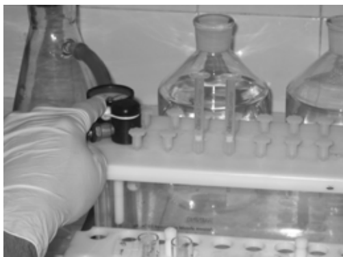
Фотографија 2. Примјена колоница и вакуум уређаја у екстракцији супстанци
